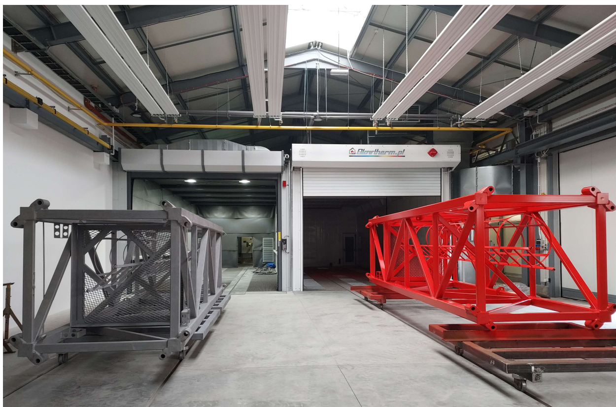
Fot. 9 Hala naprawcza z elementami konstrukcyjnymi żurawi wieżowych
