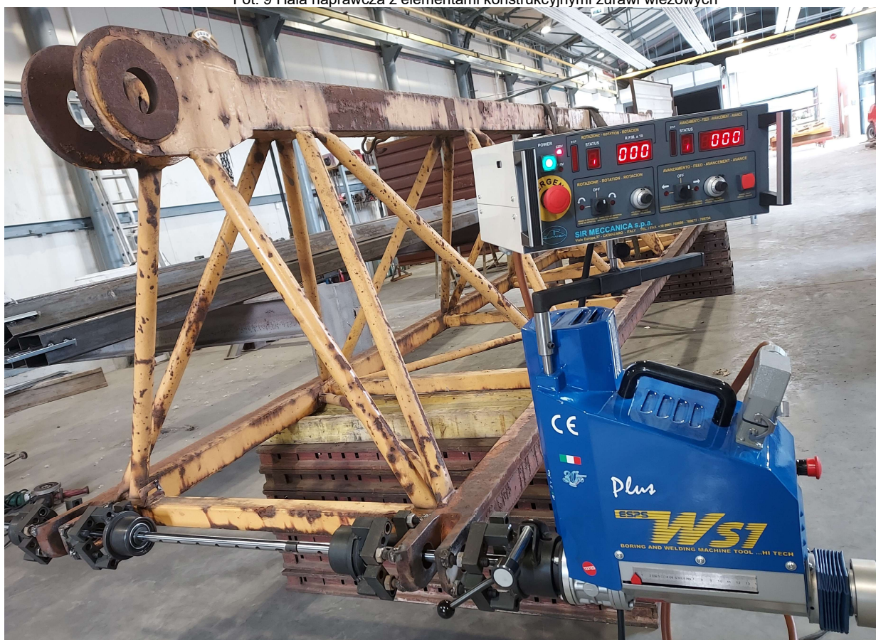
Fot. 10 Wytaczarka mobilna do regeneracji gniazd
